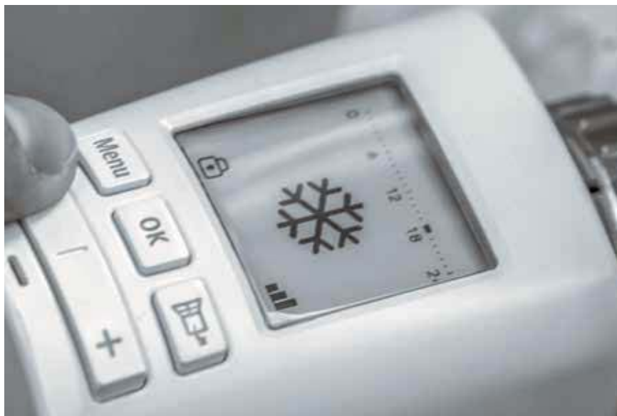
Moderne Geräte wie Smarte Heizthermostate sparen Energiekosten und heizen dann, wenn Wärme tatsächlich gebraucht wird. Foto: Pixabay
